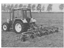
Eine wichtige Lely-Erfindung ist die Nachlaufvorrichtung Stabilo der Lely-Wender. Kurze Anhängung am Traktor, kompakt gebaut, kleiner Wendekreis und kein Schlingern in den Kurven. Der Wender lenkt schnell ein und wieder aus. Diese neue Nachlaufvorrichtung verbessert spürbar das Fahrverhalten auf dem Felde.
