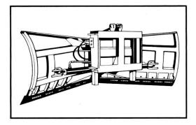
Spitzschneepflug mit hydr. schwenkbaren Seitenteilen. Arbeitsbreite 2.40 m bis 2.80 m
