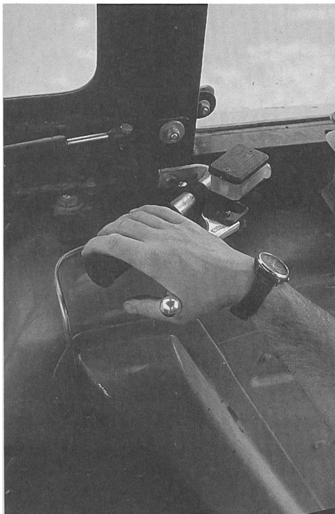
Der hydraulische Handhebel lässt sich auf jedem Zugfahrzeug in günstiger Lage montieren. Die Routine und das Fahrgefühl bestimmen die Bremswirkung.
