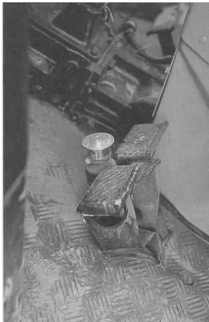
Das Ansteuerventil «Baumgartner» wird ca. 1,5 cm höher als das Bremspedal an dieses verschraubt. Unterhalb der Bremspedale muss genügend Platz vorhanden sein, damit das Ansteuerventil bei zunehmendem Pedalweg nicht auf der Bodenplatte aufsteht.
