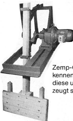
Getriebe mit Stahlzahnräder
