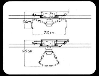
Hallenlaufkran KIWA-Elektrolift 2 TR-S, optimale Raumausnützung und Zwei-Waben-Trägebrücke, Hydraulikgreifer, Traglast 1250 kg, Hubgeschwindigkeit 15 und 30 m/min.
