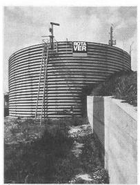
Dichter als Beton: Rotaver Güllensilos aus doppelt feuerverzinkten gewellten Stahlplatten, beidseitig kunststoffbeschich-Für jahrzehntelangen Einsatz ohne Probleme. Einfach und rasch zu montieren und bei Bedarf aufzustocken oder zu versetzen. Im Baukastensystem mit Durchmessern von 6-23 m und 50-1500 m3 Inhalt.
