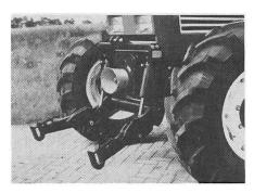
Fronthydraulik mit aufklappbaren Unterlenkern.
