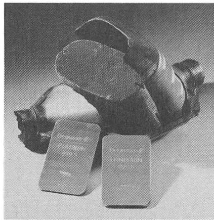
*Kreislauf des Platin durch weitgehend vollständiges Recycling: Aus verbrauchten Autoabgas-Katalysatoren gewinnt die Degussa AG die Edelmetalle wirtschaftlich zurück und erhält Rohstoffe für neue Degussa-Katalysatoren.*
