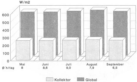
Abb. 1: Sonnenkollektoren können Zeitabschnitte mit einer Sonneneinstrahlung von 200 W/m² gut nutzen. Die Grafik zeigt einen Auszug aus den meteorologischen Daten der Stationen Payerne, Güttingen und Altdorf. Das 10-Jahres-Mittel der für Kollektoren nutzbaren Einstrahlungswerte betrug gut 570 W/m² (hintere Balkenreihe). Ein Kollektor kann daraus ca. 260 W/m² thermische Leistung erbringen. Dafür stehen ihm im Mittel 6,5 – 9 h/Tag zur Verfügung.
