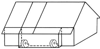
Abb. 6: Breites Lüfterhaus zum Verteilen der Luft auf zwei Lüfter.
