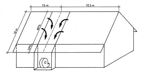
Abb. 4: Unterschiedliche Ansauglänge. Berechnung mit Programm Sonnenkollektor. Ziel: Gleiche Luftanwärmung in beiden Kollektorteilen. Weg: Berechnung mit PC-Programm mit Teillänge. Wahl der Kollektorkanalhöhen mit ca. gleicher Temperaturerhöhung und gleichem Druckverlust.
