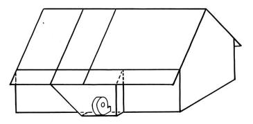
Abb. 5: Mit dem seitlich versetzten Lüfterhaus kann die Luft von einem Binderfeld zum andern umgelenkt werden.
