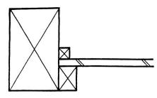
Starke Balken, kleine notwendige Kanalhöhe. Spanplatte liegt auf seitlich angeschlagener Latte. Einlegen von oben vor dem Dachdecken.
