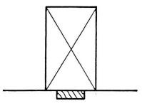
Balkenhöhe entspricht der Kanalhöhe. Unterzug aus Blachenmaterial. Anwendung vor allem bei Altbauten mit Sparrendächern.
