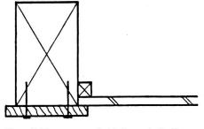
Kanalhöhe nur wenig kleiner als Balkenhöhe. Vormontiertes Brett, einlegen der Spanplatten von oben.
