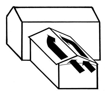
Abb.13: Der Hohlraum zwischen isolierter Stalldecke und Dacheindeckung wird «angezapft». Der Wirkungsgrad solcher Kollektoren ist zwar relativ niedrig, doch bei grösseren Dachflächen kann trotzdem eine Erwärmung der Luft um mehrere °C erreicht werden.
