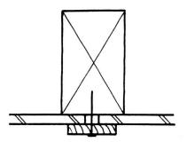
Balkenhöhe entspricht der notwendigen Kanalhöhe. Spanplatte unten bündig mit Brett befestigt.
