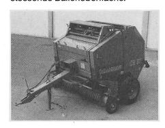
Die Heckklappe ist mit einer umlaufenden, automatisch geschmierten Stabkette versehen. Dies reduziert den Kraftaufwand beim Pressen und garantiert ein sicheres Drehen der Ballen auch bei sehr trockenem Gerstenstroh. Dabei kann die Zapfwelle während dem Auswerfen der Ballen laufen gelassen werden, was einen wesentlichen Bedienerkomfort darstellt.
