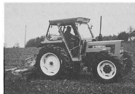
Planetenvorderachse bis 50° Lenkeinschlag, Lift-O-Matic, Vario-Speed und Senkdrossel sowie zentralem, unter Last schaltbarem Allradantrieb verstehen sich von selbst. Und nicht zuletzt die wichtigen Elemente der Sicherheit: z.B. die im Getriebe plazierten Ölbad-Scheibenbremsen;
