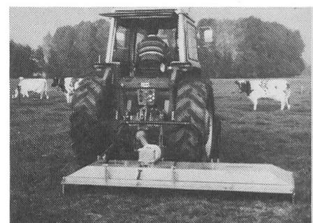
den Obstbau als Schlegel- oder Sichelmulchgeräte angeboten. Feines Zerhacken und gleichmässiges Ablegen der Weidereste sind wesentliche Vorteile gegenüber dem üblichen Ausmähen. Perfect-Weidemulchgeräte sind kompakt und stabil gebaut. Der Antrieb über Vollölbgetriebe und Keilriemen bringt Sicherheit und auch die An- und Abkopplung ist einfach und schnell.
