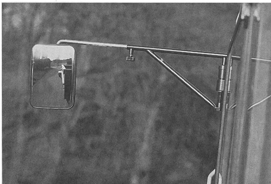
Die ausziehbaren Spiegelarme der BUL mit den unzerbrechlichen Rückspiegeln ermöglichen den wichtigen Blick nach hinten auch bei breiten Anhängern oder beim Ladewagen.
