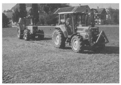
Abb. 2: Schlupfanlage: Ein Zugtraktor von 3 t wird vom Bremstraktor (4 t) so stark abgebremst, dass der gewünschte Schlupf von 6, 12 oder 18% entsteht.
