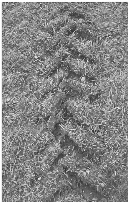
Abb. 6: Durchfahrt auf feuchter Wiese mit 18% Schlupf. Die Grasnarbe wird fast vollständig vom Unterboden abgerissen und in der Fahrtrichtung verschoben.
