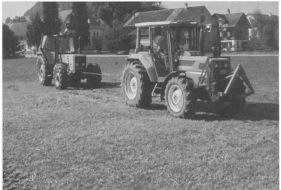
Abb. 2: Schlupfanlage: Ein Zugtraktor von 3 t wird vom Bremstraktor (4 t) so stark abgebremst, dass der gewünschte Schlupf von 6, 12 oder 18% entsteht.
