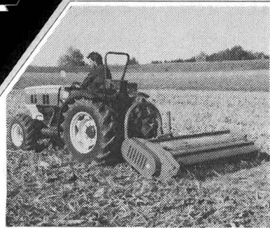
In einem Arbeitsgang wird die abgegraste Weide gemäht, die Kuhfladen werden aufgenommen und die gesamte Mulchmasse zerkleinert dem Boden als organischer Dünger wieder zugeführt.
