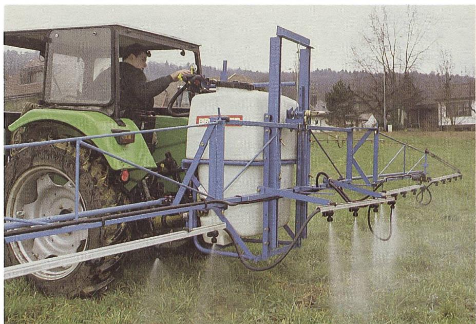
*Der SVLT hat in Zusammenarbeit mit der FAT für die Feldspritzen-Tests neue Richtlinien ausgearbeitet. In den 15 Prüfkreisen, die sich in der Regel mit dem Einzugsgebiet der Sektionen decken, sind im Laufe dieses Frühlings gegen 350 Feldspritzen dem Test unterzogen worden. Deren Funktionstüchtigkeit und Zuverlässigkeit bescheinigen ein Attest und ein Kleber.*
