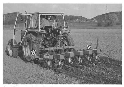
Abb. 3: Die mechanischen Einzelkornsämaschinen mit Parallelogramm-Tandem geführten Sägeräten können bei der Rübensaat mit den pneumatischen durchaus konkurrieren.
