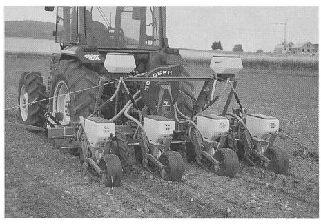
Abb. 4: Mit pneumatischen Einzelkornsämaschinen lassen sich mit einer Säscheibe alle Maiskaliber ohne Kornbeschädigung aussäen. Die Ausrüstung mit einem Granulatstreuer ist bei allen Fabrikaten möglich.
