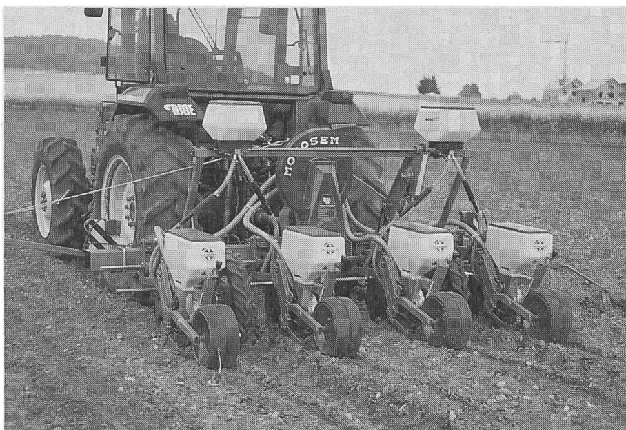
Abb. 4: Mit pneumatischen Einzelkornsämaschinen lassen sich mit einer Säscheibe alle Maiskaliber ohne Kornbeschädigung aussäen. Die Ausrüstung mit einem Granulatstreuer ist bei allen Fabrikaten möglich.
