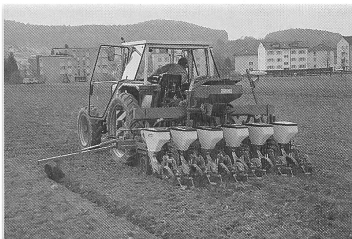
Abb. 1: Mit den pneumatischen Einzelkornsämaschinen lässt sich bei fachgerechter Handhabung eine gute Arbeitsqualität bei der Rüben-, Mais-, Acker- und Sojabohnen-Saat erreichen. Rechts: Gleichmässige Pflanzenabstände bei Mais.
