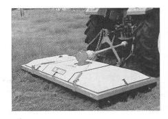
prägte Grasführungen gewährleisten bei optimaler Arbeitsweise Mähen, Zerkleinern und Verteilen über die gesamte Maschinenbreite.
