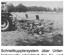
lenkerwelle erleichtert das An- und Abkoppeln des Kreiselzettwenders. Aufgrund der Nachlaufeinrichtung folgt der Kreiselzettwender spurtreu dem Traktor. Stabilisatoren gewährleisten ein ruhiges Fahrverhalten bei der Arbeit in schweren Futtermassen und auf unebenem Untergrund.
