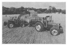
Allrad-Zuschaltung beim Bremsen und elektrohydraulische Einschaltung der Differentialsperre. Der Allradantrieb wird mittels Knopfdruck zugeschaltet. Teleskopstabilisatoren und Anhängerbremsventil sind Standardausrüstung.
