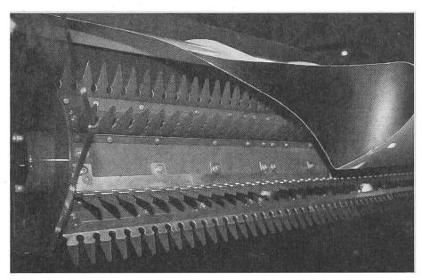
Die aus England stammende Entwicklung des «Strippers» ist ein Aufbau am Mähdrescher, der das normale Mähwerk ersetzt und die Ähren mittels 8 elastischen Kämmen am Rotor vom Halm trennt. Da die Masse des Strohs nicht mehr durch den Mähdrescher geschickt wird, ergibt sich eine grössere Leistungsfähigkeit. Gemäss Firmenangaben lässt sich vor allem Getreide mit zum Teil noch grünen Halmen besser dreschen.
