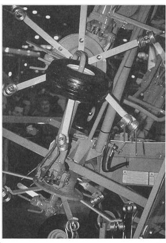
Den Kraftschluss am Kuhn GF 8500 garantiert eine verblüffend einfache Fingerverzahnung (DIGIDRIVE), und zwar in jeder Stellung der Kreiselarme zueinander.
