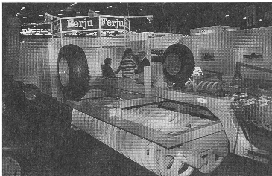
Eine originelle Lösung, um das Problem des Strassentransportes von über 3 Meter breiten Arbeitsmaschinen zu lösen.
