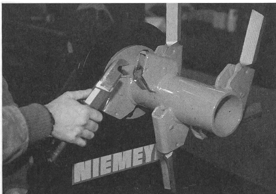
Die Bedienungs- und Wartungsfreundlichkeit ist ein wichtiges Verkaufsargument. Zahnwechsel: Aus- und Einklinken – fertig.
