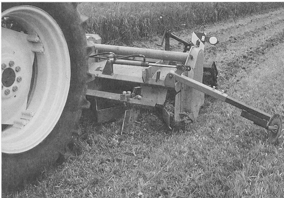
Wichtig bei der Streifenfrässaat ist die gründliche Bearbeitung des Frässtreifens. Damit bei starken Niederschlägen das Wasser unten abfließen kann, muss mit einem Grubberzahn pro Reihe genügend tief gelockert werden.
