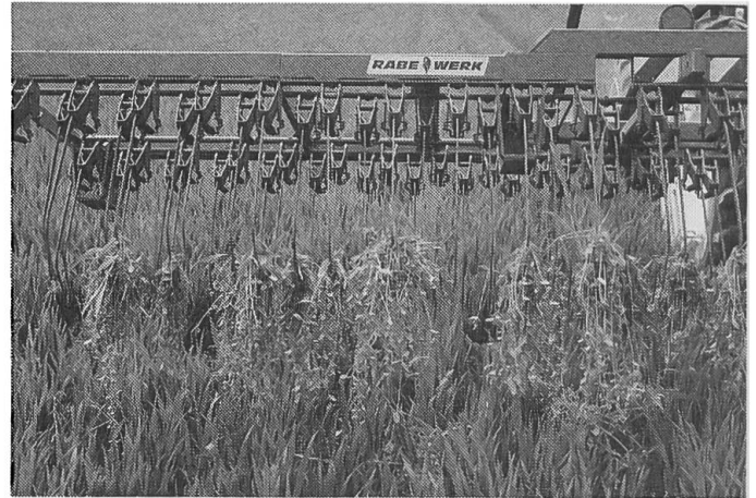
Abb. 3: Mit dem letzten Striegeleinsatz von Fahrgassen aus, bei 40 – 50 cm Getreidehöhe, werden meist nur Vogelmiere und Klettenlaubkraut durch «Auskämmen» reduziert. Dabei müssen die Zinken öfters gereinigt werden.
