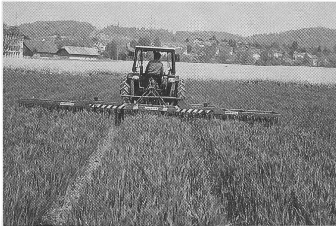
Abb. 3: Mit dem letzten Striegeleinsatz von Fahrgassen aus, bei 40 – 50 cm Getreidehöhe, werden meist nur Vogelmiere und Klettenlaubkraut durch «Auskämmen» reduziert. Dabei müssen die Zinken öfters gereinigt werden.
