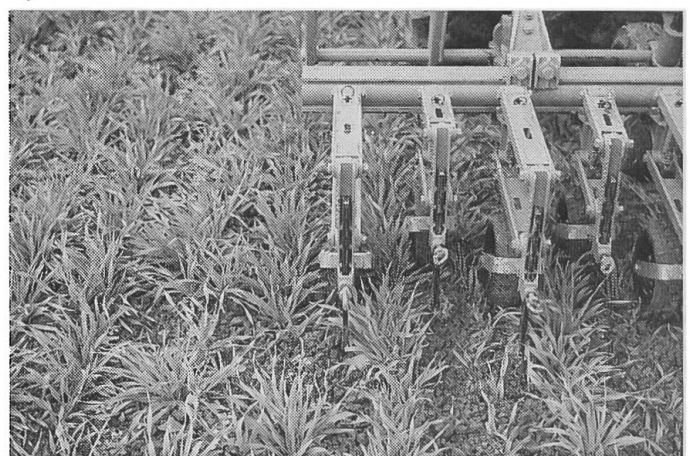
Abb. 4: Mit dem Scharhackgerät werden die meisten Unkräuter nur zwischen den Reihen bekämpft. Der Arbeitseffekt wird durch einen zusätzlichen Striegeleinsatz wesentlich verbessert. Leichte Traktoren mit Doppelbereifung (erster Einsatz) bei niedrigem Reifenluftdruck um 0,6 bar sind vorteilhaft.
