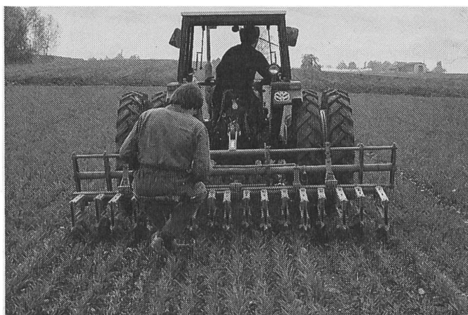
Abb. 4: Mit dem Scharhackgerät werden die meisten Unkräuter nur zwischen den Reihen bekämpft. Der Arbeitseffekt wird durch einen zusätzlichen Striegeleinsatz wesentlich verbessert. Leichte Traktoren mit Doppelbereifung (erster Einsatz) bei niedrigem Reifenluftdruck um 0,6 bar sind vorteilhaft.
