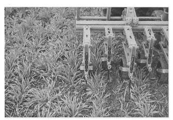
Abb. 4: Mit dem Scharhackgerät werden die meisten Unkräuter nur zwischen den Reihen bekämpft. Der Arbeitseffekt wird durch einen zusätzlichen Striegeleinsatz wesentlich verbessert. Leichte Traktoren mit Doppelbereifung (erster Einsatz) bei niedrigem Reifenluftdruck um 0,6 bar sind vorteilhaft.
