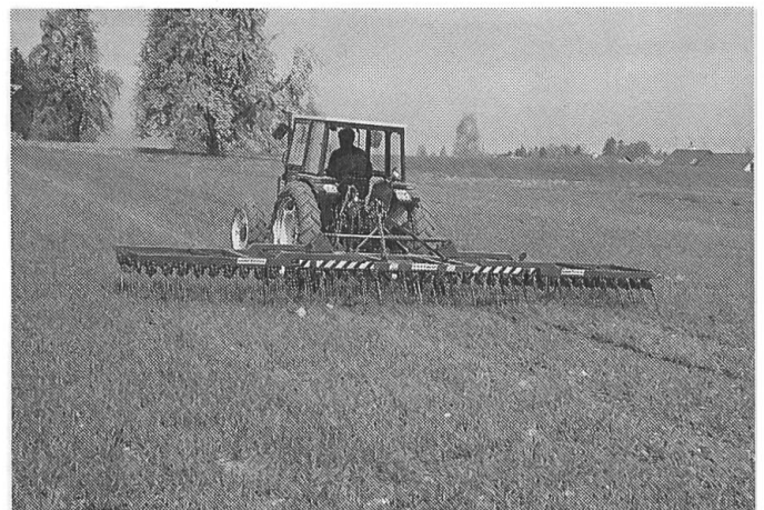
Abb. 1: Durch einen rechtzeitigen zwei- bis dreimaligen Striegeleinsatz lassen sich eine genügende Unkrautverminderung und eine wirksame Bodenpflege erreichen.
