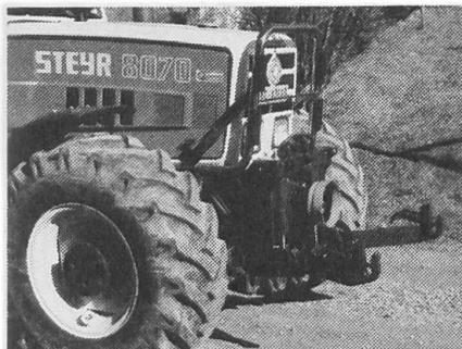
sind mit Schnellfanghaken ausgerüstet. Eine grosse Hubkraft und ein günstiges Preis-Leistungs-Verhältnis sind weitere Merkmale. Die Fronthydraulik wird in drei Grössen hergestellt. Auf Wunsch kann diese Hydraulik auch doppelwirkend geliefert werden. **Bruno Villiger, Mechanische Werkstätte, Niederrohrdorf**
