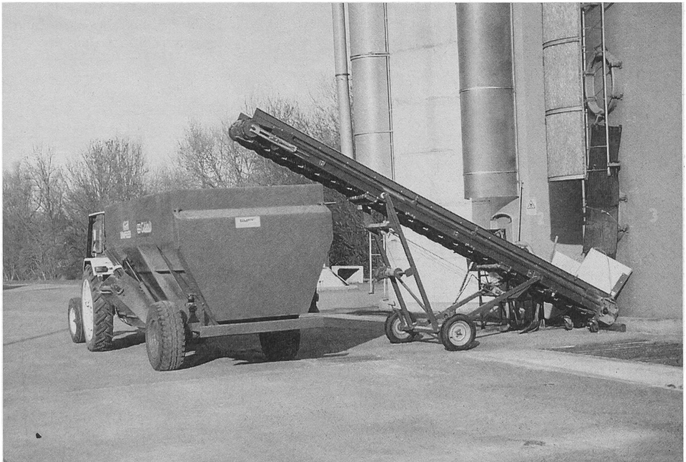
Sichere Arbeitsweise: Indirektes Befüllen mit einem Förderband.
