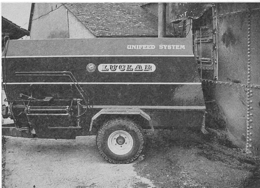
Gefährliche Arbeitsweise: Futtermischwagen rückwärts zum Hochsilo gestellt...
