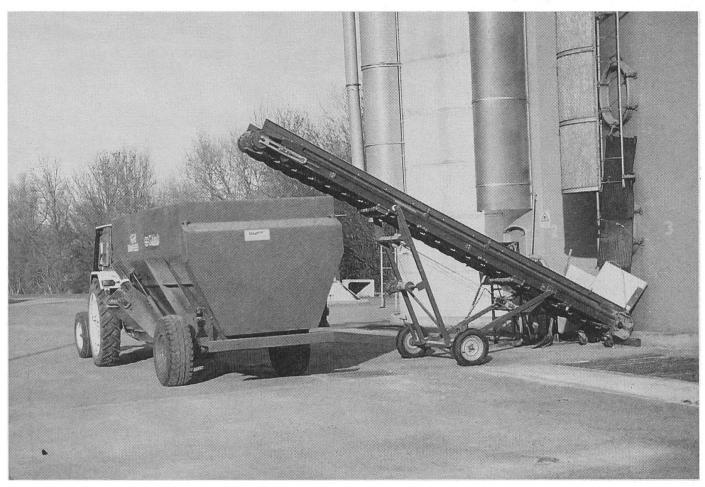
Sichere Arbeitsweise: Indirektes Befüllen mit einem Förderband.
