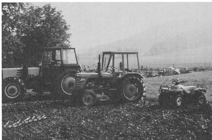
Abb. 3: Vergleich verschieden schwerer Fahrzeuge: Reifengrösse und Radlast bestimmen den Bodendruck.
