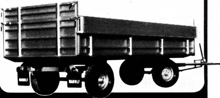
Ein technisch und qualitativ hochstehender Pneuwagen mit einem Ges. Gewicht von 9 Tonnen, Brückengrösse 500 x 200 cm, Höhe ab Boden 90 cm. Aluminium-Seitenbretter 50 + 50 cm eloxiert, Michelin-Bereifung, 4-Rad-Auflauf- und Fall-Deichselbremse. Gewichtseinsparung durch Verwendung von Alu-Seitenbrettern ca. 130 kg. Der Color 84, leicht, handlich und trotzdem robust.
