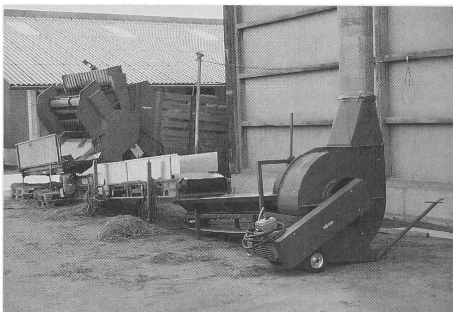
Abb. 3: Eine zwischen Dosiergerät und Zubringerband des Gebläses geschaltete Bandwaage erhob den Durchsatz und die Regelmässigkeit des Futterflusses.
