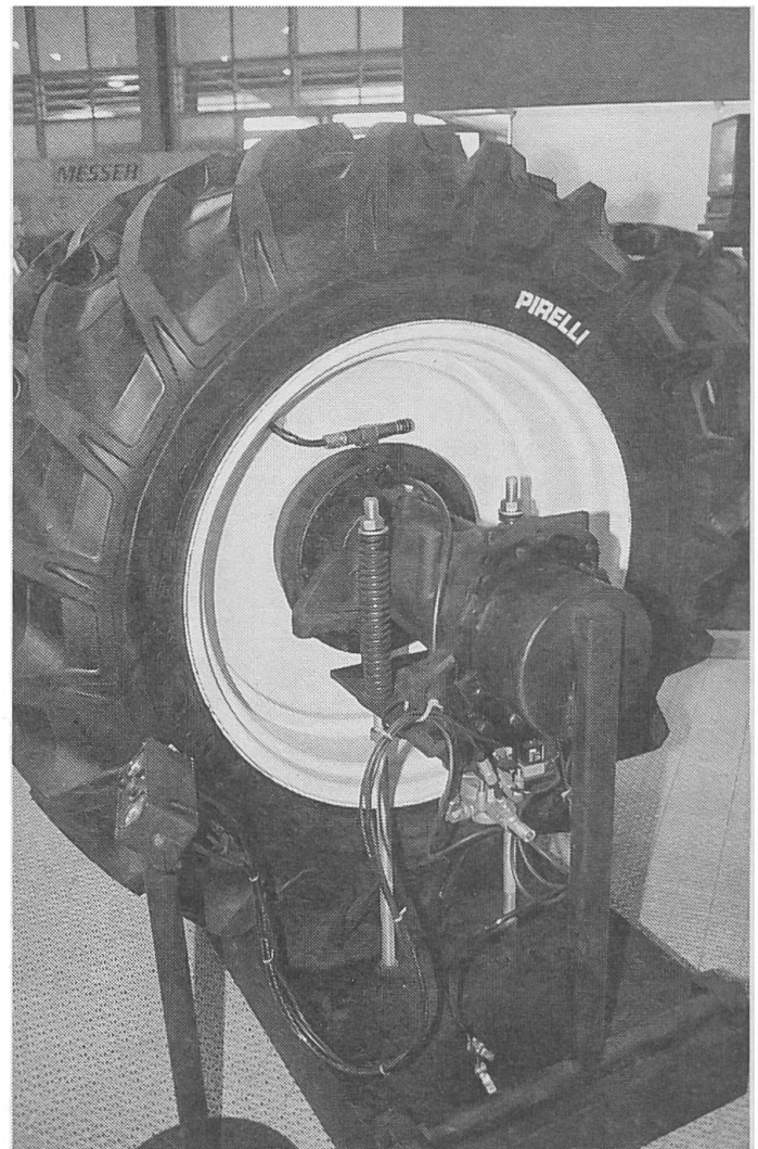
Luftdruckregulierung zur Reduktion des spezifischen Bodendruckes auf dem Stand der Gebr. Schaad, Subigen. Speziell tragfähige Reifen (Kleber) sollen übrigens einen Beitrag zur Schonung der Ackerböden leisten.
