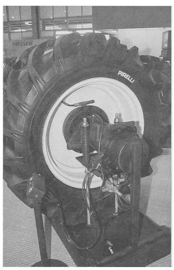
Luftdruckregulierung zur Reduktion des spezifischen Bodendruckes auf dem Stand der Gebr. Schaad, Subigen. Speziell tragfähige Reifen (Kleber) sollen übrigens einen Beitrag zur Schonung der Ackerböden leisten.
