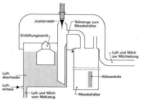
Abb. 13: Funktionelle Teile von Milkoscope I.
