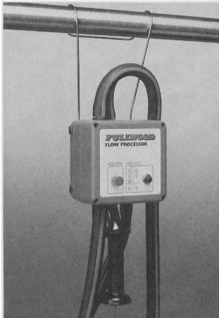
Abb. 8: Steuerungskasten der Melkeinheit Flow Processor mit Signallampe und Funktionstaste.
