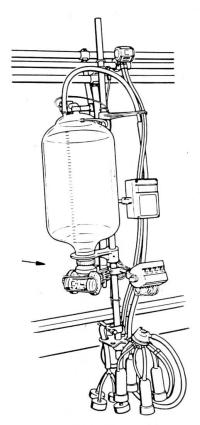
Abb. 15: Das Milchmengen-Messgerät JM 100 ist unten am Messbehälter befestigt (Pfeil). Von jeder Kuh wird die Milch im Messbehälter gesammelt und erst nach der Melkzeugabnahme durch JM 100 abgepumpt. Das Gerät JM 100 ist im Prinzip eine Kolbenpumpe mit definiertem Volumen von 100 ml pro Hub.
