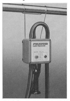
Abb. 8: Steuerungskasten der Melkeinheit Flow Processor mit Signallampe und Funktionstaste.
