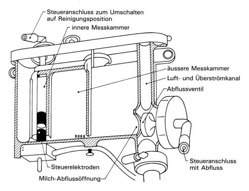
Abb. 16: Schnitt durch das Milchmengen-Messgerät Metatron 12 mit seinen funktionellen Teilen.
