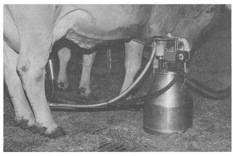
Abb. 3: Duovac 300 auf einer Standeimer-Melkanlage.
