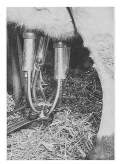
Abb. 1: Der Bio-Milker zeichnet sich durch spezielle Sammelstücke und Ventile an den Zitzenbechern aus.
