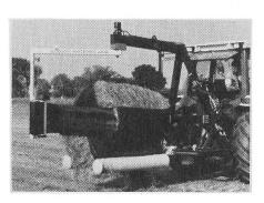
Dass die Ballen nach dem Wickeln wieder sanft auf dem Boden abgelegt werden, um die Folie zu schonen und ein Wegrollen im hügeligen Gelände zu verhindern, bleibt weiterhin eine Spezialität von «System Bee». Zu bemerken ist, dass beide vollautomatischen Modelle trotz der hochstehenden Technik ein Preisvergleich kaum zu scheuen brauchen.
