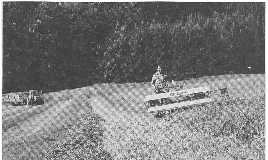
Abb. 1: Motormäher/Ladewagen: Das verbreitetste, sehr bodenschonende, aber keineswegs das billigste Eingrassverfahren.
