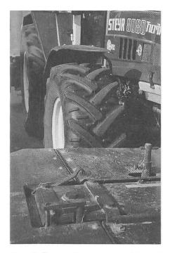
Abb. 8: Frontmäher drücken mit rund 1 Tonne auf die Vorderachse und verlangen eine entsprechende Bereifung.
