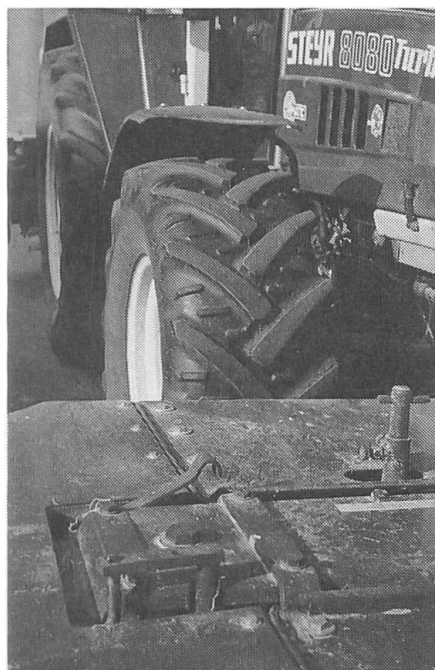
Abb. 8: Frontmäher drücken mit rund 1 Tonne auf die Vorderachse und verlangen eine entsprechende Bereifung.
