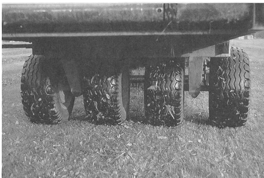
Abb. 9: Dem Boden zuliebe sollte bei grossen Ladewagen die Last auf vier Räder verteilt werden.
