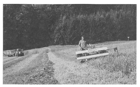
Abb. 1: Motormäher/Ladewagen: Das verbreitetste, sehr bodenschonende, aber keineswegs das billigste Eingrasverfahren.
