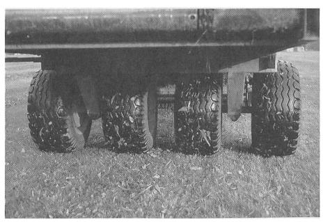
Abb. 9: Dem Boden zuliebe sollte bei grossen Ladewagen die Last auf vier Räder verteilt werden.
