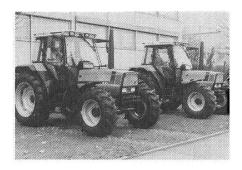
Mit Deutz-Fahr Agrostar in die Zukunft Diese Traktorenreihe Agrostar umfasst den Leistungsbereich von 95–143 PS. Es sind dies die Typen DX 4.71, DX 6.11, DX 6.31, DX 6.61.
