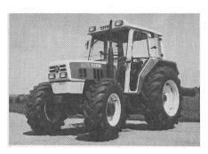
Die neuen Steyr-Reitsitztraktoren mit RS-2-Kabine stellen preisgünstige Komforttraktoren dar. Sie verfügen über Seitenschaltung, Geräuschdämmung, Bedienungsfreundlichkeit, Heizlüftung, Dachscheinwerfer und weit höhenverstellbarer Anhängekupplung.
