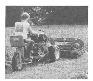
Mit dem Mäh-Sitzwagen fahren, mähen und wenden Sie mühelos. Kunden bestätigen uns, dass dadurch das Mähen oder das Arbeiten mit dem Band- oder Kettenheuer wesentlich erleichtert wird. Der Sitzwagen kann mit wenigen Handgriffen montiert oder demontiert werden.
