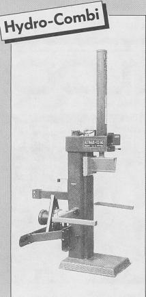
Mit einem Holzspalter der **Hydro-Combi**-Serie. **10, 20** oder **30 t** Spaltkraft. Sie spalten vertikal bis 1,1 m oder horizontal bis 2,5 m Länge. Problemlos.
