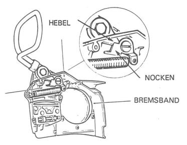
Der Bremsmechanismus in Kupplungsdeckel muss gründlich gereinigt werden. Das verölte Bremsband ist mit Benzin zu waschen. Berührungsfläche zwischen Hebel und Nokken mit Schmierfett bestreichen.
