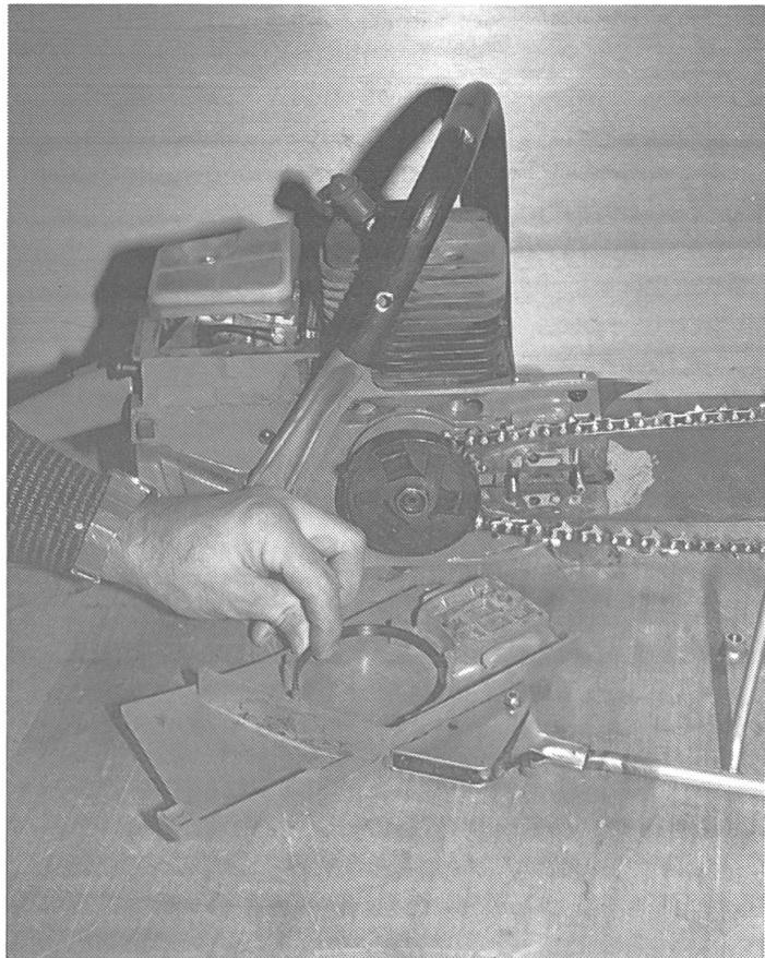
Bremsband mit Zeigefinger und Daumen hinsichtlich Abnützungserscheinungen prüfen und Bandmitte mit Bandende vergleichen. Bei fühlbarem Verschleiss oder bei Rissen durch Überhitzung ist das Bremsband sofort durch eine Fachwerkstätte ersetzen zu lassen. Foto: P. Brügger
