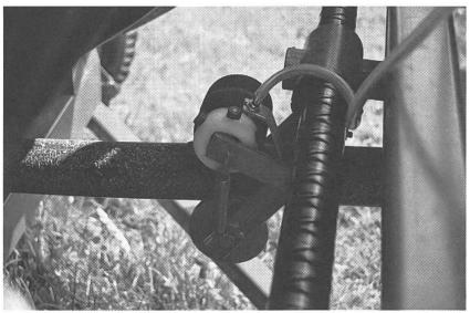
Abb. 6: Mit einer Tastmessrolle wird am Einzugsrohr die Einzugsgeschwindigkeit ermittelt und elektronisch mit dem eingegebenen Sollwert verglichen. Abweichungen vom Ist- und Sollwert werden über den Stellmotor am By-Pass-Ventil ausgeglichen.
