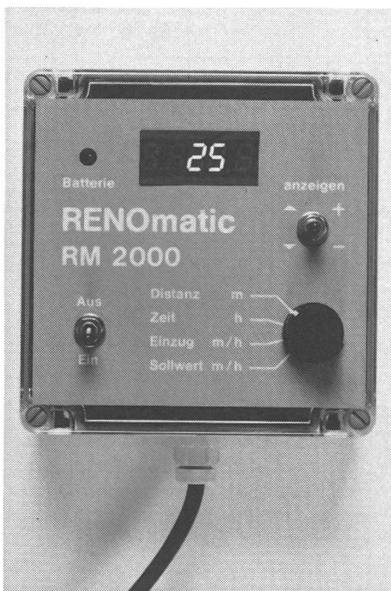
Abb. 6: Mit einer Tastmessrolle wird am Einzugsrohr die Einzugsgeschwindigkeit ermittelt und elektronisch mit dem eingegebenen Sollwert verglichen. Abweichungen vom Ist- und Sollwert werden über den Stellmotor am By-Pass-Ventil ausgeglichen.
