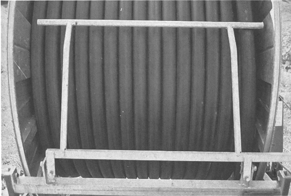
Abb. 5: Durch die Tastwelle wird die Veränderung des Umfangs jeder Rohrlage erfasst und der Antrieb der Rohrtrommel gesteuert.
