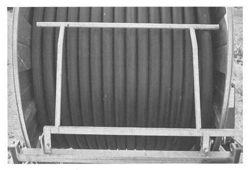
Abb. 5: Durch die Tastwelle wird die Veränderung des Umfangs jeder Rohrlage erfasst und der Antrieb der Rohrtrommel gesteuert.
