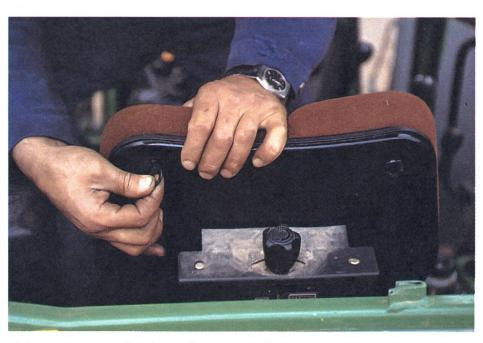
Bei verschiedenen Fabrikaten lässt sich die Polsterung mit Schnellverschlüssen montieren und demontieren.
