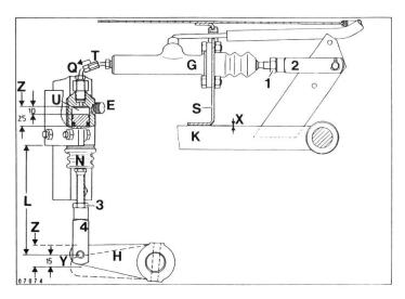
Skizze 1: Hydraulische Fahrwerkkupplung einstellen (aus Betriebsanleitung zu Claas DOMINATOR 108 S/98 S)
