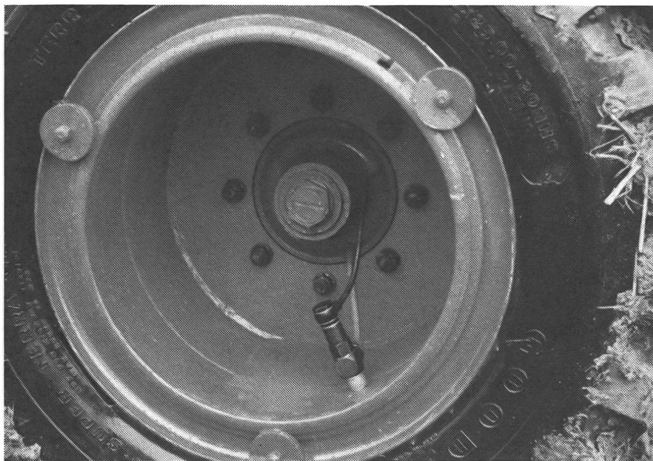
Luftdruckventil in der Felgenschüssel mit je einer Luftleitung für die Steuerung und die Lufteinspeisung.
