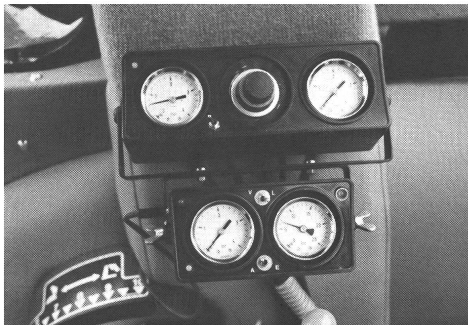
Steuerkonsole in der Traktorkabine oben: Reifendruckregelung am Traktor unten: Reifendruckregelung am Druckfass bzw. am Anhänger
