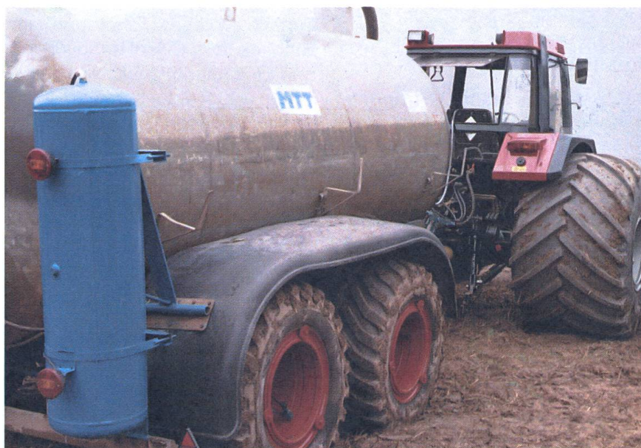
Der häufige Wechsel zwischen der Fahrt auf der Strasse und auf dem Acker lässt eine Reifendruckregelanlage vor allem am Druckfass als sinnvoll erscheinen. Links befindet sich einer von zwei Luftdruckkesseln mit je 160 Litern Inhalt.
