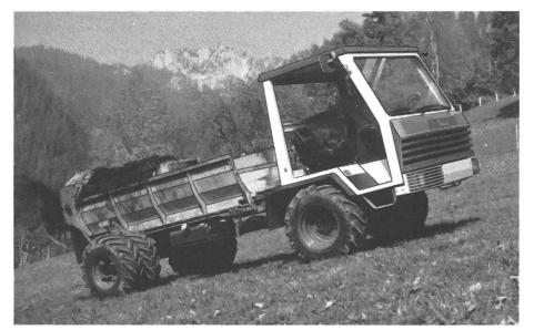
Rapid Altrac 3000 41,5 kW (56,5 PS) Grosse Nutzlast dank robuster Bauart
