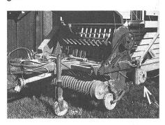
Hydraulischer Kratzbodenantrieb au Ladewagen, Nachrüst-Bausatz vor Tractotech.
