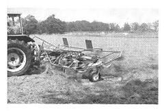
Zur Standardausrüstung gehören Superballonbereifung, zentrale Grenzstreueinrichtung, werkzeuglose Streuwinkelverstellung, hydraulisch einklappbare Kreisel für den Transport u.v.a.m.
