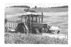
Durch das günstige Leistungsgewicht und die Wendigkeit ist der 304 LSA, zusammen mit der Frontzapfwelle und Fronhydraulik, der ideale Grünlandtraktor. Dazu gehört auch die Bereifung 375/75R20 vorne und 16.9R30 hinten.
