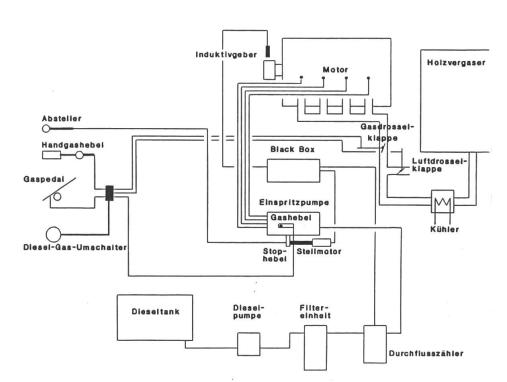
Schema der Diesel-Holzgas-Anlage.
