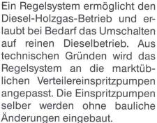
Beim Diesel-Holzgas-Betrieb wird die Einspritzmenge reduziert, indem der Abstellhebel je nach Bedarf bedient wird. Diese Funktion wird durch einen mechanischen und einen elektronischen Teil des Steuerungssystemes erledigt:
