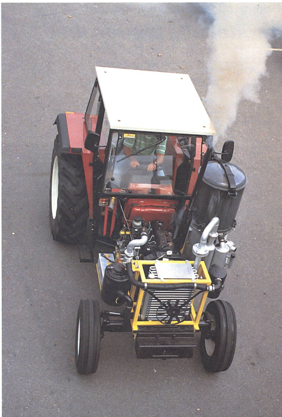
Praktische Fahrversuche auf dem Gelände der HTL Brugg-Windisch. Je nach Gefühl der Fahrer mit oder ohne Rauch und Gestank. Für weitere Einsätze müsste der Holzvergaser sowie das Mischventil optimiert werden.
