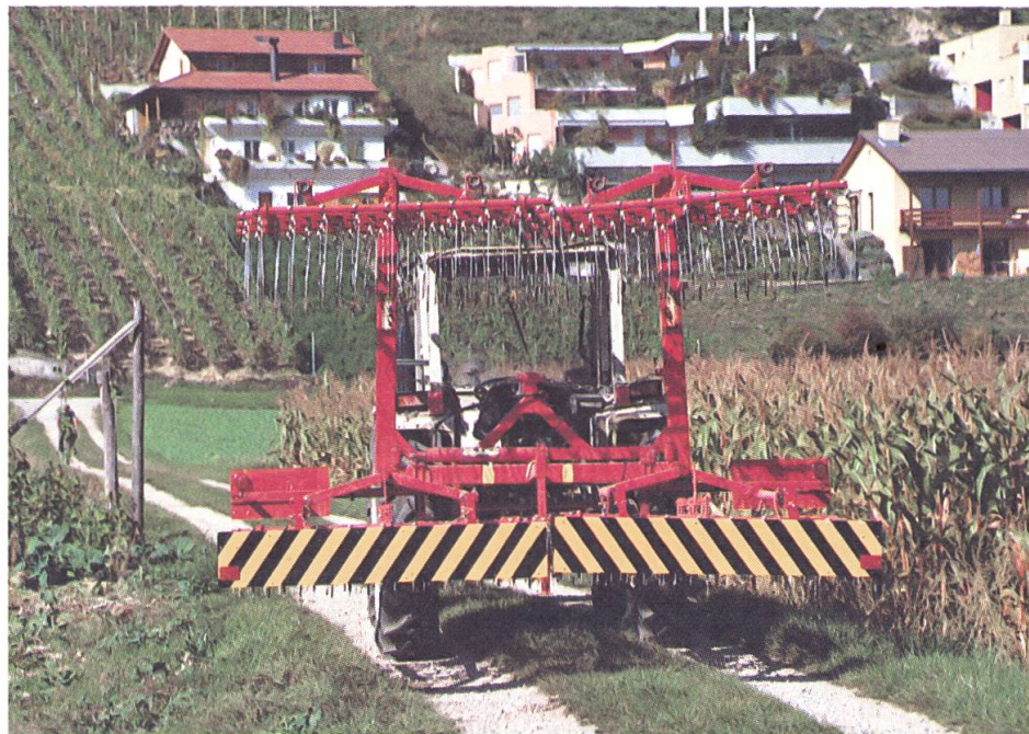
Abb. 3: Die Abdeckung der Zinken und Kanten dient gleichzeitig der Breitenmarkierung.
