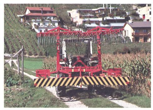
Abb. 3: Die Abdeckung der Zinken und Kanten dient gleichzeitig der Breitenmarkierung.
