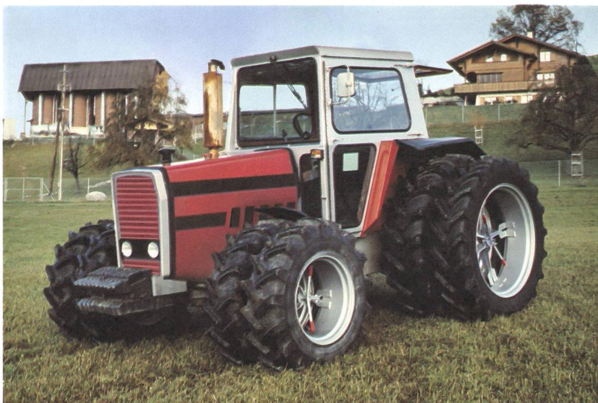
Ein moderner Traktor, ausgerüstet mit 4 Müller Doppelrädern.
