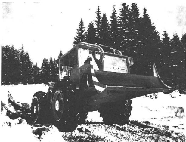
mit Knicklenkung, Doppeltrommelwinde.
