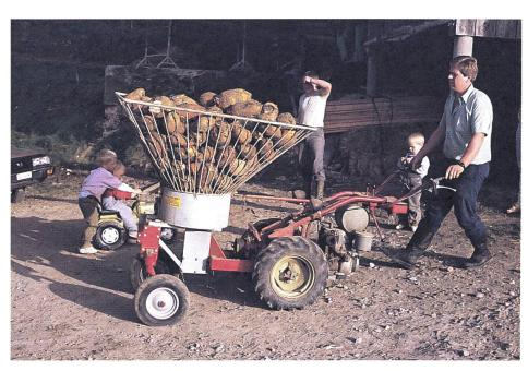
Mittel und Wege, um die Entnahme und Verfütterung von Rüben zu erleichtern: Mobiler Rübenschnitzler auf dem Motormäher oder an der Drei-Punkt-Hydraulik. Foto: Huber, FAT
