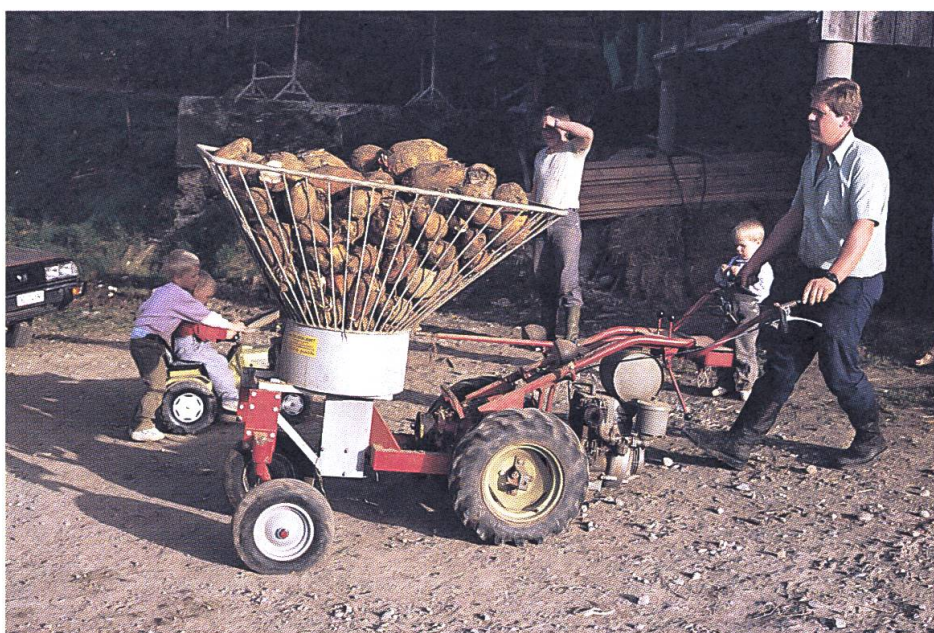
Mittel und Wege, um die Entnahme und Verfütterung von Rüben zu erleichtern: Mobiler Rübenschnitzler auf dem Motormäher oder an der Drei-Punkt-Hydraulik. Foto: Huber, FAT
