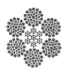
Querschnitt eines Drahtseiles mit Stahlseele in Seale-Konstruktion.
