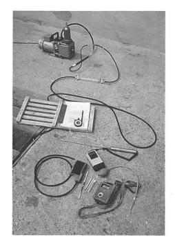
Abb. 2: Einige der verwendeten Messgeräte. Im Hintergrund Gasprobe für gaschromatografische Analysen, im Vordergrund Gasspürröhrchen, Thermometer und H<sub>2</sub>S-Messgerät.
