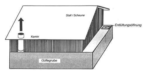
Abb. 15: Güllegrube vollständig unter dem Gebäude: In Ausnahmefällen ist je nach Gebäude- und Geländesituation eine sichere Lösung mit einem Entlüftungsventilator möglich.
