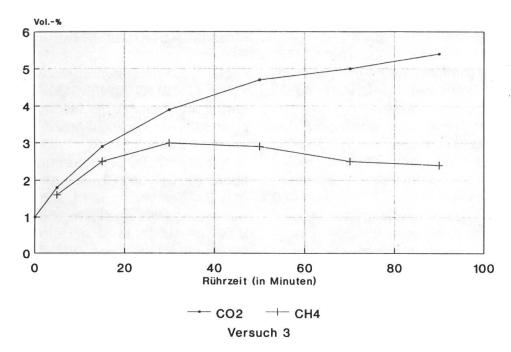
Abb. 4: Verlauf der Schadgaskonzentrationen bei Versuch 3
