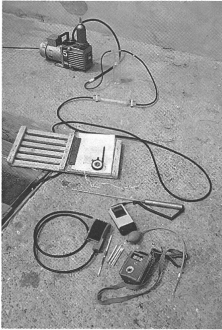
Abb. 2: Einige der verwendeten Messgeräte. Im Hintergrund Gasprobe für gaschromatografische Analysen, im Vordergrund Gasspürröhrchen, Thermometer und H 2 S-Messgerät.
