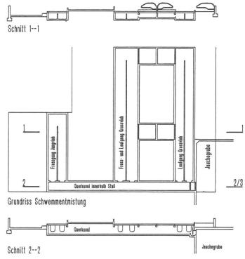
«Gasverschluss» zwischen Stallbereich und Güllegrube: Gasverschluss beim Einlauf in die Güllegrube: Die Stau- oder Treibmistkanäle werden in einen Querkanal entleert. Dieser mündet, ohne Gefälle, über eine Staunase in den Syphonierungs-Schacht mit Tauchschürze (Syphonplatte) und Kontrollöffnung. Kann langes Einstreumaterial in den Schacht gelangen (z.B. durch Flachschieber), sollte die Tauchschürze hochgezogen werden können.
