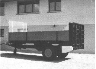
Vier stehende Fräswalzen. Breite Streumöglichkeit. Stahlbordwände 50 cm. Schutzgitter. Gelenkwelle. Farmerstopbremse. Beleuchtung. Kratzboden vor- und rückwärtslaufend. Hintere Stahlbordwand. Die Maschine ist auch mit zwei liegenden Fräswalzen lieferbar. Die Zettaggregate sind an beiden Maschinen in fünf Minuten zu demontieren und schon steht Ihnen ein Anhänger mit Kratzboden zur Verfügung.
