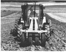
Ideal sind Frontpacker, welche hydraulisch belastet werden können und somit mit dem Traktorgewicht den Boden rückverfestigen. Um den Traktor lenkbar zu erhalten, werden diese Packer über ein Gestänge oder hydraulisch gesteuert. Dazu eignen sich fast nur Front-Reifenpacker. Sie können an der Fronthydraulik angebaut werden, oder mit integriertem Hydrauliksystem eignen sie sich zum Anbauen an alle Traktoren.
