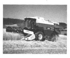
lässigkeit der Antriebselemente. Der 6000 Liter umfassende Korntank erlaubt dem Fahrer einen grossen Aktionsradius. Die grossen Sichtflächen der klimatisierten Panorama-Kabine, ausgerüstet mit Check-Control, Hektaren-Zähler, integriertem Körnerverlustmonitor, bieten dem Fahrer mittels Einhandbedienung über vierstufiges Hydrostaten-Getriebe optimale Sicherheit, einfache Kontrolle und ein kompromissloser Komfort am Arbeitsplatz. *Agrotec AG*, *Siglistorf*
