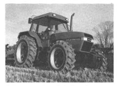
richtungsweisend sind, weil sie dem Landwirt echten Nutzen bieten. Das lastschaltbare Wendegetriebe, über das sich die Fahrtrichtung sofort und weich, aber ohne Betätigung des Kupplungspedals ändern lässt, ist ein weiteres, zukunftsweisendes Konstruktionsmerkmal, so wie die MAXX-O-DRAULIC mit SHR-gesteuerter Hubregelung mit druck- und mengengeregelter Axialkolbenpumpe.
