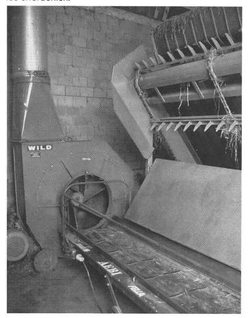
Auch bei Maschinenkombinationen mit verschiedenen Fabrikaten müssen alle Schutzvorrichtungen vorhanden sein. Hier fehlt der spezielle Ansaugtrichter zwischen Gebläse und Zubringeband.
